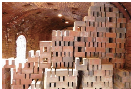
▲焼成室ごとにレンガを積み上げ、天井から粉炭を投入して焼成した。
