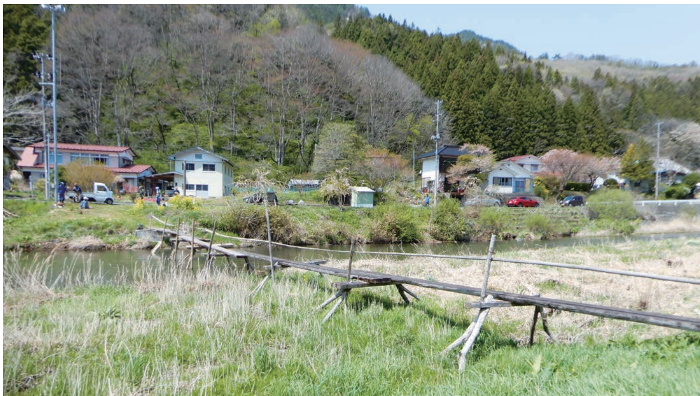
▲ でき上がった松日橋は、遠目には、昆虫のナナフシみたいでドボかわいい。橋の架け方は体験を通して地元の人々に代々受け継がれてきた。橋架けの機会が頻繁にあるからこそ、技術が失われずに継承されているのだろう
