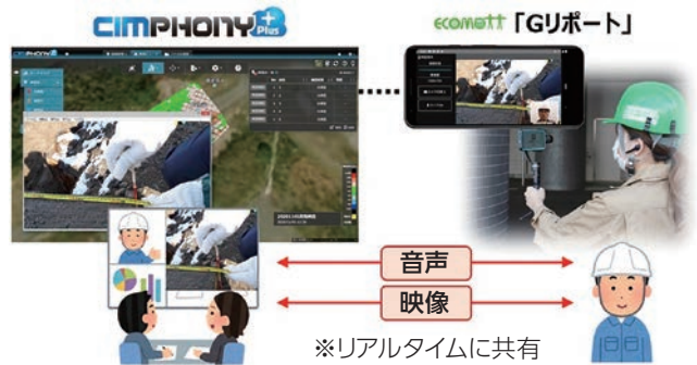
●遠隔臨場システムのイメージ。発注者(左側)はオフィスにいないが、現場(右側)から送られてきた映像を見て、立会検査を行う(資料:福井コンピュータ)
