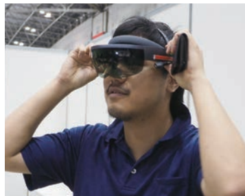
●現場と図面を同じ大きさ、角度で重ねて見られるARゴーグル (写真:筆者)
