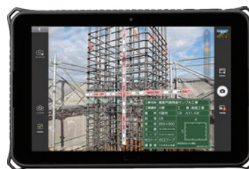
● 頑丈なタブレットで工事写真を現場で整理できるシステムの例 (写真:ルクレ)
