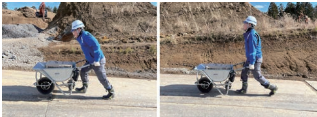
●ねこ車電動化キットの効果。通常のねこ車で斜面を登るときは力がいり遅くなる(左)が、電動化キットを取り付けたねこ車はらくに早く運搬できる(右)(写真:CuboRex)
