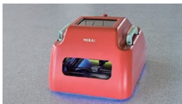
●現場の床に設備の取り付け位置などを描く「墨出しロボット」の例(写真:未来機械)
