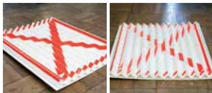
山折り・谷折りが連続する蛇腹式のカーテンの構造を応用した、自動車の逆走防止装置。逆走車両側のみに通行止めのマークが認識される仕掛けとしている。「道路に敷設することを想定し、グレーチングとして排水機能をもたせつつ、逆走を知らせられるデザインとしました。試行錯誤を重ねた経験は、生徒たちにとって色濃いものになったと思います」と高原先生
